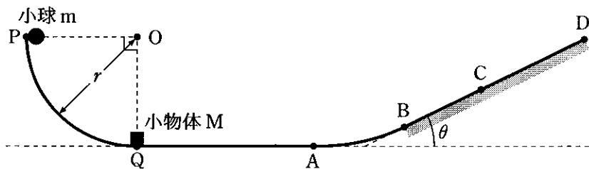
衝突の直後、小物体 M は、速さ  $V = \boxed{1}$  で水平面上を右方向に運動し始め、B 点を通過したときから時間  $t$  後にあらい斜面上の C 点で停止し、そこにとどまった。このことから、小物体 M が B 点を通過するときの速さは  $\boxed{2}$  であり、B 点から C 点までの距離  $L$  は、 $L = \boxed{3}$  となる。摩擦力がした仕事の大きさは、小物体 M が失った力学的エネルギーに等しいので、C 点の水平面からの高さ  $H$  は、 $H = \boxed{4}$  と求められる。
