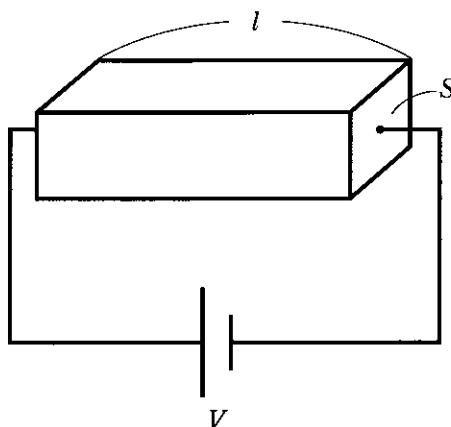
金属棒中の自由電子は、電圧  $V$ [V]により発生する一様な電界(電場)から大きさ  $f = \boxed{7}$  [N]の力を受け加速される。このままでは電子の速さは増大し続ける。しかし、実際には電子は熱振動する金属イオンと不規則に衝突を繰り返す。この効果を十分長い時間で平均すると、電子は一定の速さ  $\bar{v} = \frac{f t_0}{m}$  [m/s]で金属棒の長さ方向に運動するとみなすことができる。ここで、 $t_0$ [s]は、ある1つの衝突から次の衝突が起こるまでの平均の時間で、平均自由時間といわれる。
