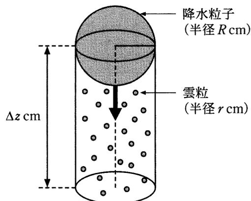
図2-1 降水粒子が落下しながら雲粒と衝突し、とらえる様子を示した模式図
