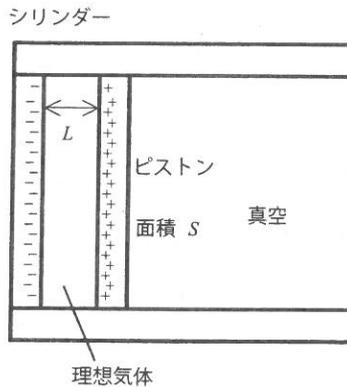
図 3-1 理想気体を入れたシリンダー-ピストンの模式的断面図
