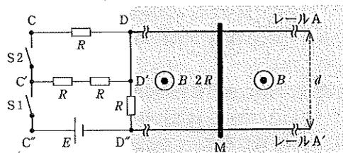
起電力 $E$ [V]の電池が1つ、スイッチS1、S2が、図のように配置されている。Mのレール間の電気抵抗は $2R$ 、電池の内部抵抗や導線、レールの電気抵抗は無視でき、回路を流れる電流によって生じる磁場の影響はないものとする。
