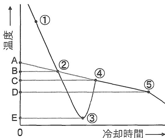
図1 希薄な塩化ナトリウム水溶液の冷却曲線
