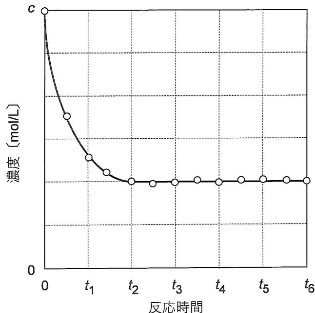
図1 反応時間に対する酢酸の濃度変化
