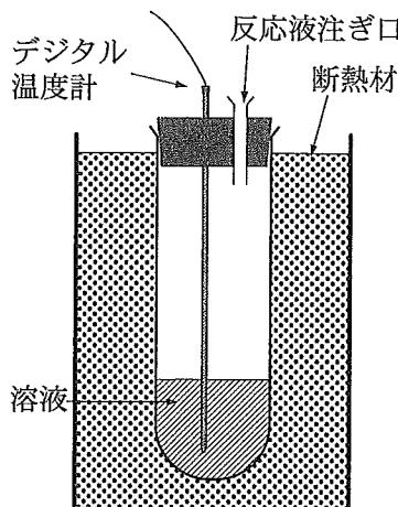
**【実験A】** 試験管に0.10 mol/Lの塩酸55mLをメスシリンダーで測り取り、栓をした。温度が安定したところで液温を測り、反応前(0分)の温度とした。次に1.0 mol/Lの水酸化ナトリウム水溶液5.0 mLをホールピペットで測り取り、ガラス管から直接注いだ。直ちに装置全体をよく揺すって溶液を混ぜてから温度を測定した。水酸化ナトリウム水溶液を加えるとすぐに温度が上昇して、その後徐々に温度が下がってくる。各時間での測定値は表のようになった。
