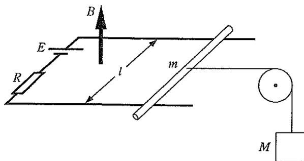
問19 はじめ、手で図中の水平方向右向きの力を加えて金属棒を静止させておいた。このとき手が加えている力の大きさはいくらか。
